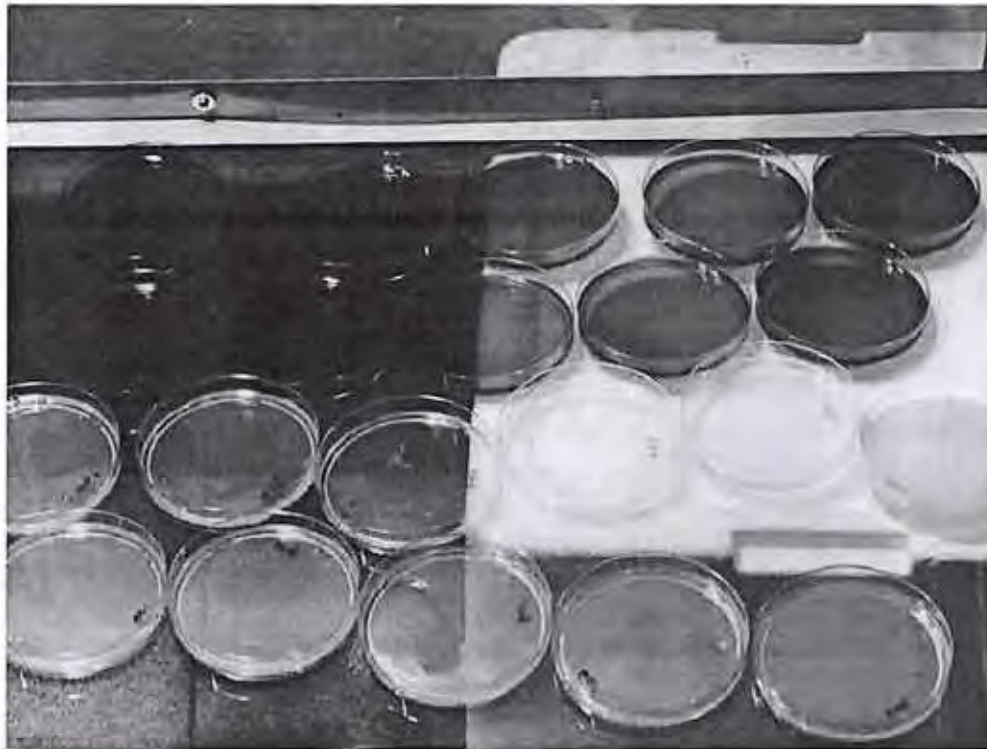
Fig. 4 Piastre di EMB, AC e BP seminate già disposte all'interno della cabina ed esposte alla pellicola.
